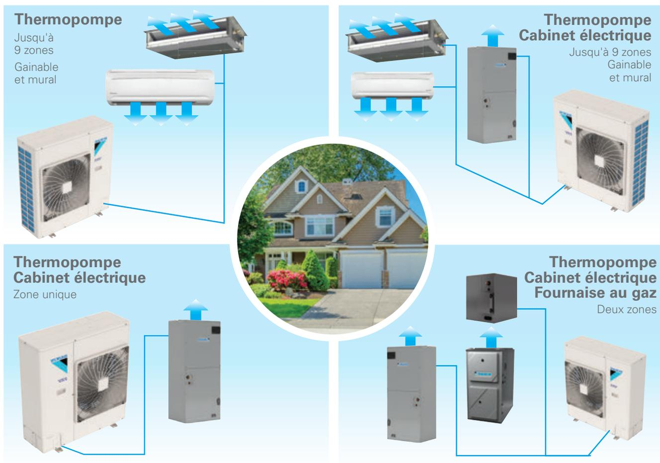
Les systèmes Daikin VRV LIFE™ sont la première pompe à chaleur VRV de l'industrie dotée d'une connectivité avec les générateurs d'air chaud au gaz pour une utilisation résidentielle. Les nouveaux systèmes VRV LIFE offrent des solutions aux problèmes de sonorisation, d'espace, de zonage et d'efficacité pour des applications résidentielles individuelles.
