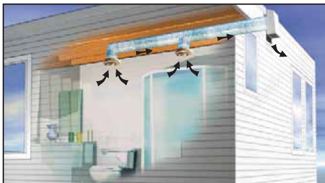
Ventilation double de salle de bain
